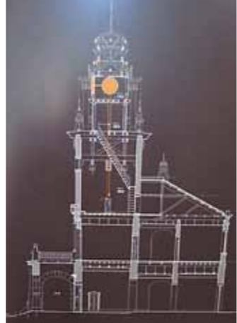
写真10:時計台の側面図。博物館長の特別の案内で、細い急な階段を登り塔屋の上部も見学させて頂いた。時計の動力は電気やネジ巻き式でなく、分銅の上下動であった(設計図のオレンジ部分)。大時計の文字盤のシャフトに時計の器械部分が直接ついているのではなかった。器械本体は文字盤から遙か下にある塔内の床の上に据えられており(側面図では階段を登りきった処の上方フロア)、そして器械のシャフトと文字盤のシャフトは長いチェーンで繋がれていた。なるほど! そういう仕組みなのか。このような仕組みの時計塔は初めて見た。英国のピックベンのような巨大な歯車や振り子を装備する大仕掛けではない。智慧が詰まった109年前に建てられた時計塔であった。
